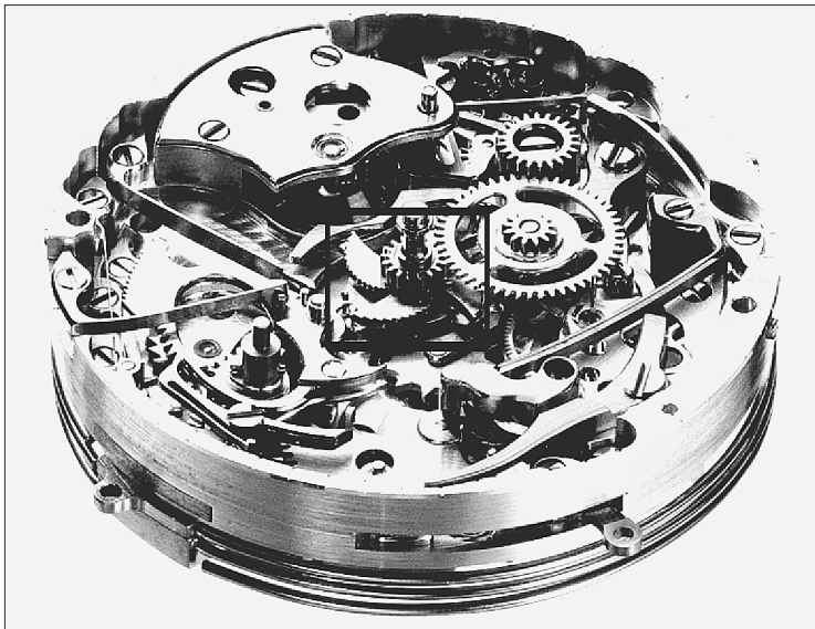
Au centre du mouvement, la came des minutes avec ses quatre pales (© Renaud & Papi).
